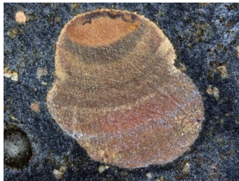
Étude pétrographique d'un boulet de calibre 116 mm en basalte, épave Mortella III .
